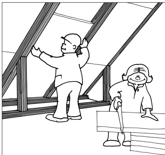
Ukiadanie izolacji styropianowej pomikdzy krokwiami w dwuch, wzajemnie przesunietych warstwach
