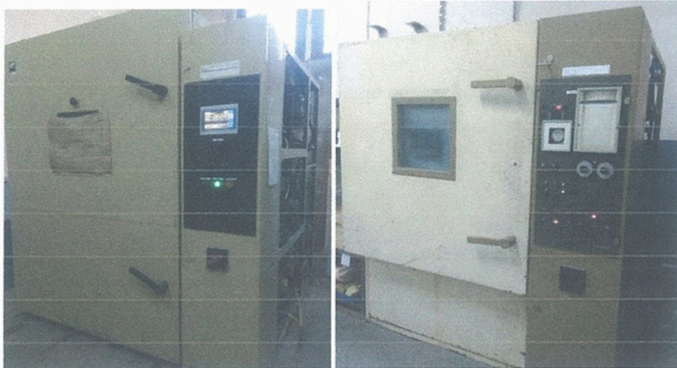
Рисунок 3 – Кліматичні камери для проведення циклічних кліматичних впливів
