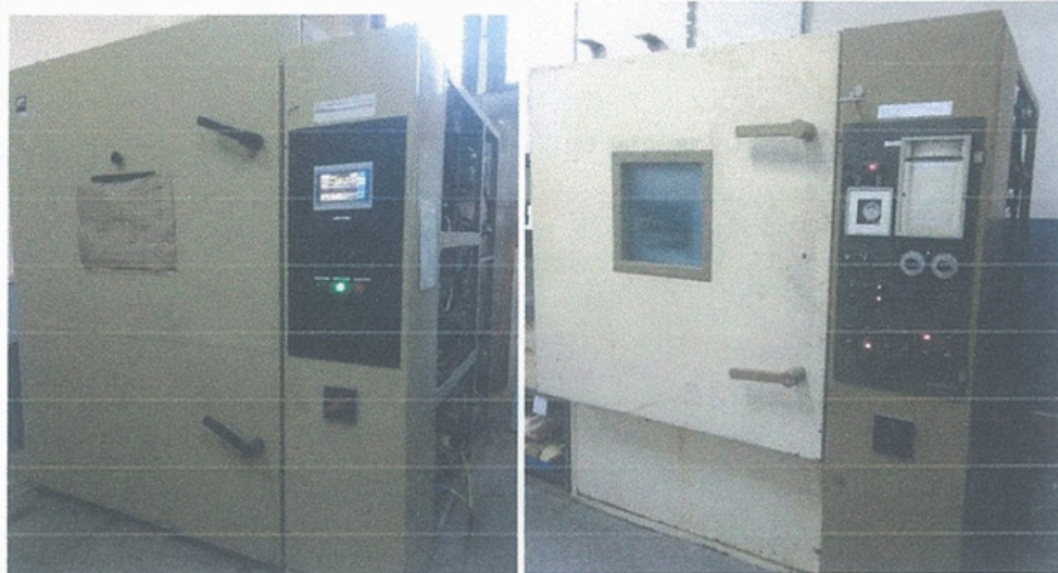
Рисунок 3 – Кліматичні камери для проведення циклічних кліматичних впливів
