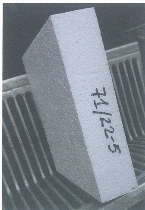
Рисунок 3 – Загальний вигляд зразків №70/22 та №71/22 теплоізоляційного матеріалу плит пінополістирольних EPS 70 та EPS 80 (TM Eurobud, TM Styrotherm, TM Ecotherm, TM BauGut) під час випробувань
